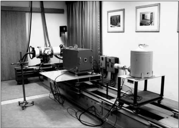
Figura 4. - Camera a ionizzazione ad aria libera: standard nazionale per la grandezza esposizione in aria a raggi X (media e bassa frequenza) fino al 1993.
