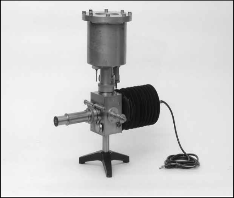
Figura 1. - Elettrometro di Lutz monofilare a filo teso progettato da Cesare Trabacchi nel 1942 (inventario n. 22).
