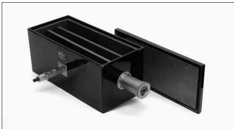
Figura 5. - Camera di ionizzazione standard per dosimetria con raggi X, già nell'inventario della collezione, è stata la prima camera standard primario, realizzata da Trabacchi negli anni '40 (inventario n. 389).
