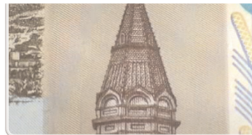
Fotomicrografía del dispositivo "Motion", capa conteniendo microtextos. La división de la escala es de 10 micrones.
