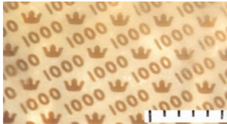
Fotomicrografía del dispositivo "Motion", capa conteniendo microtextos. La división de la escala es de 10 micrones.
