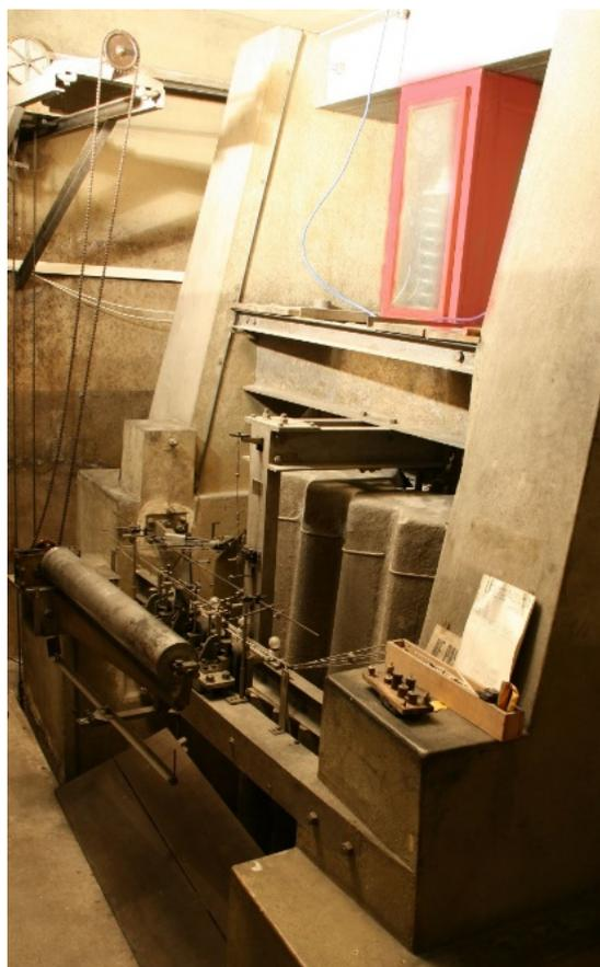
*Fig. 17* : Photographie du sismographe « de Quervain-Piccard » en 2014. Le cabinet en bois (en rouge) a été rajouté à une date indéterminée.
